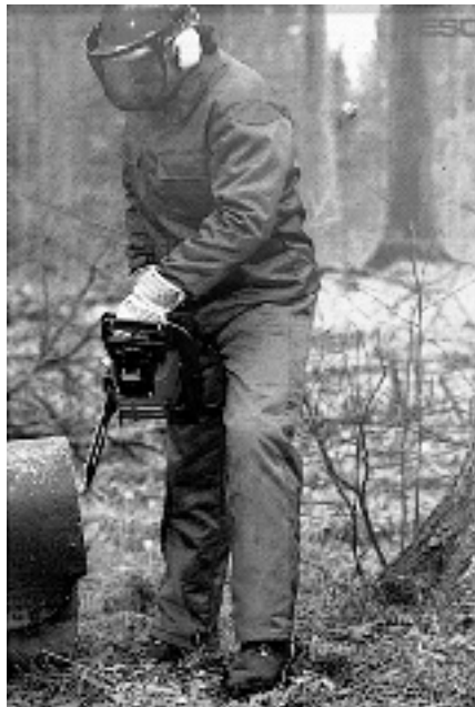
Abbildung 15: Beispiel einer Schnittschutzhose nach DIN EN 381 Teil 5
