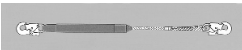
Bild 13: Aufreiß-Falldämpfer (Bandfalldämpfer) mit Verbindungsmittel und beiderseitigem Karabinerhaken
